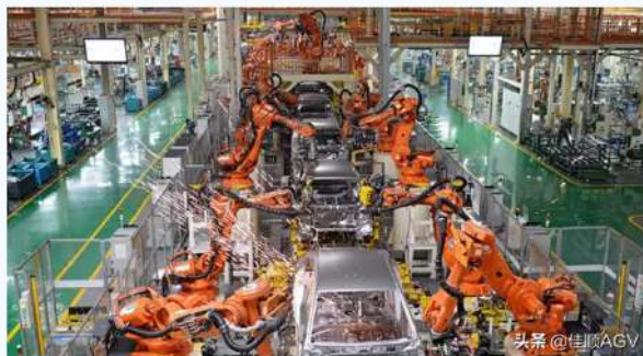
H社自動車メーカー 車体工場溶接ライン (ロボット60+台)
